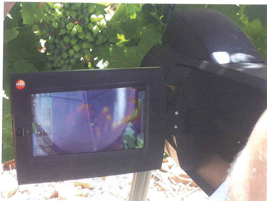
Foto 2. Detalle de la medición con cámara termográfica.
