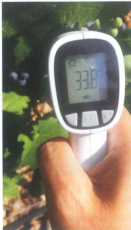
Foto 3. Detalle de la medición con pistola de infrarrojos.
